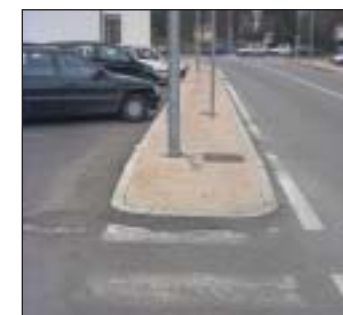
B1-11 - 17 Esempi di ostacoli causati dall'errato posizionamento degli elementi di arredo urbano.
