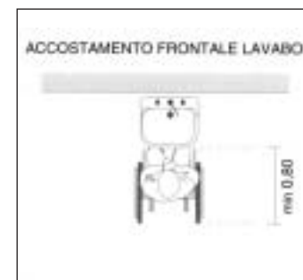
A1-14 Spazio minimo libero frontale al lavabo: 80 cm., per l'accostamento frontale
